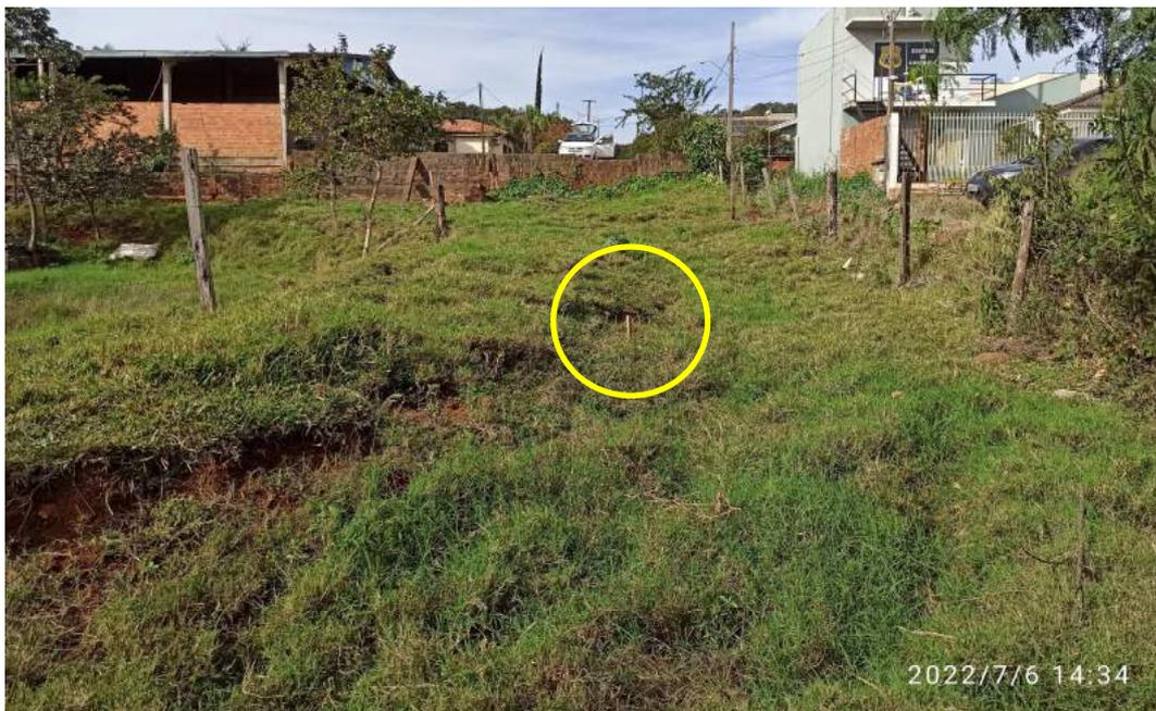
**Figura 07** – Demarcação com estacas do alinhamento do limite da Rua Carlos Turri (largura de 7,50 m), representando a divisa com Lote Rural nº 28 – 1º Parte. Sendo possível visualizar o muro de contenção aos fundos, que gera uma barreira e um desnível acentuado em relação ao terreno natural existente no local.
